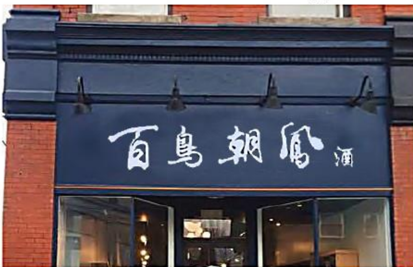
铝板喷漆 + 印刷字贴片 D-09
